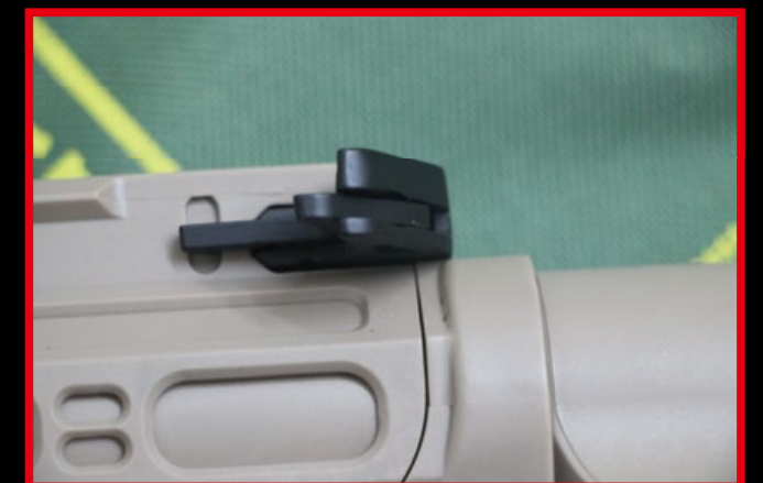
馬蓋普式樣的槍機拉柄還設有輔助器。
