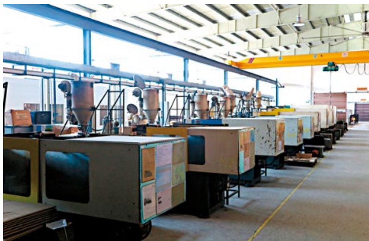
MSB廠內的塑料機部門，所有的工程塑料握把及尾托都由此生產出來的。
